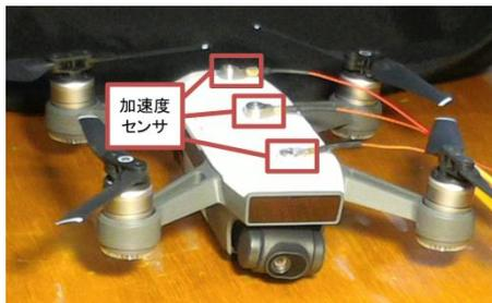
図5 落下試験に用いたドローン機体
