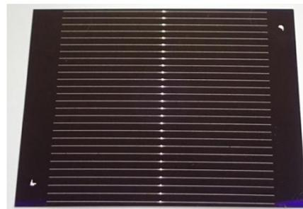
図8 レーザー溝加工による試作セル
