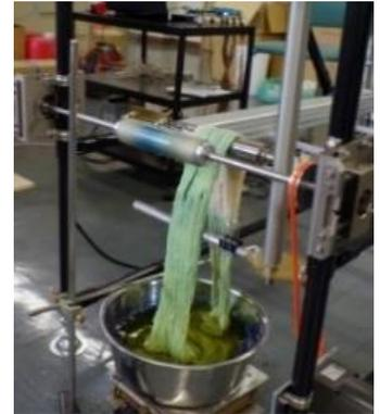
図 1 試作した染色装置
