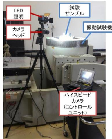
図2 振動試験状況
