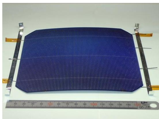
図 1 8 市販サイズ MWT 太陽電池セル
