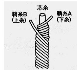
図1 カバリング加工系概念図
