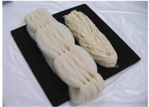
図2 新規シルクデニット糸(右:解編前、左:解編後)
