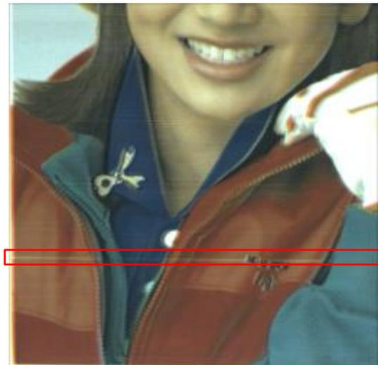
図8 ノズル抜けとした画像
