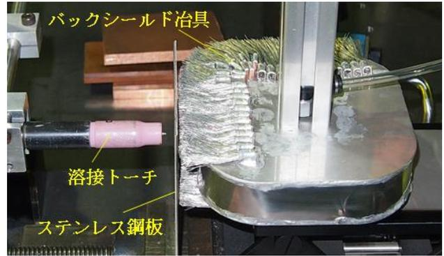
図4 スポット溶接実験の風景（直線部用）
