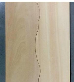
図10 6mmオフセットによる切削結果
