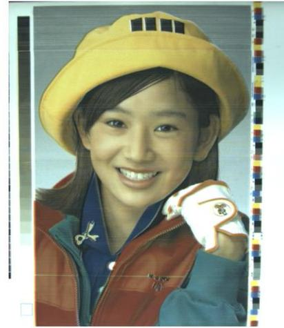
図7 ノズル抜けや色ずれを起こした実際の不良画像
