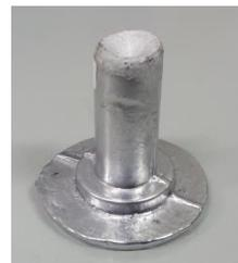
図1 カントバック試験片
