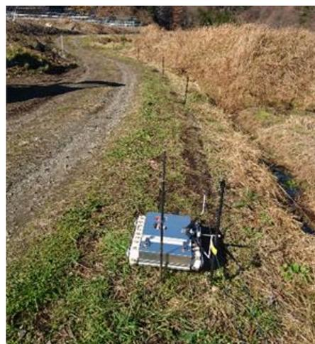
図10 石筵圃場での除草走行実験の様子
