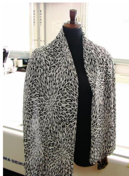
図6 試作した新規シルクデニット糸編地
