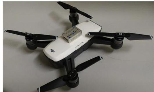
図11 ドローン機体へのケーブルレス型加速度センサユニットの取付状況
