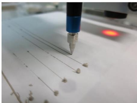
図 1 5 細線印刷実験結果（終端部）
