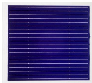
図10 裏面エッチング加工による試作セル
