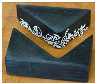
図18 平面3D模様から2次曲面模様へ変形
