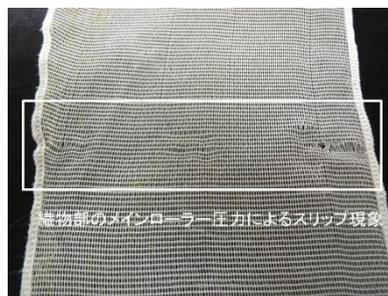
図 5 ローラー圧による織物スリップ現象
