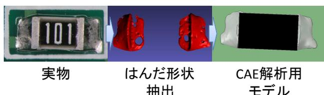
図3 三次元モデリングの概要
