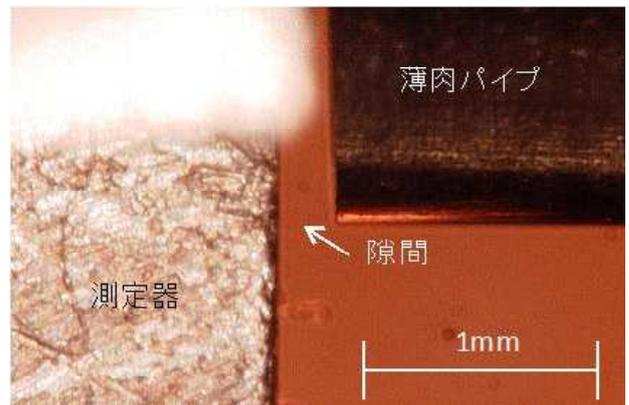
図6 測定器と薄肉パイプとの隙間
