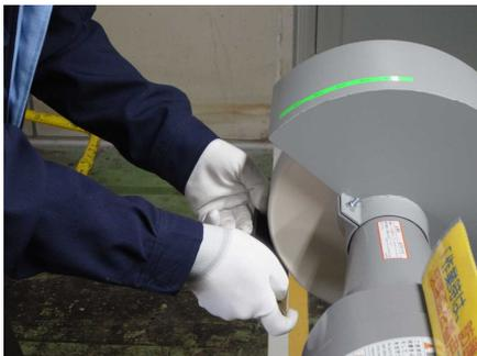
図3 バフ研磨作業状況
