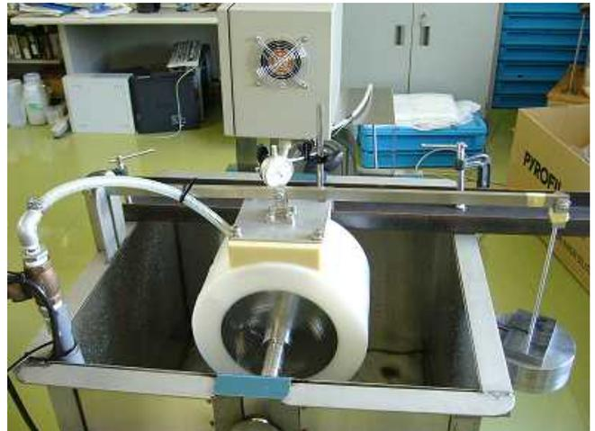
図3 1/1サイズ摺動試験機
