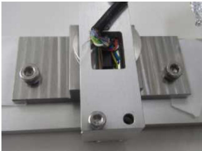
図6 回転ステージを用いたスケールの評価の様子
