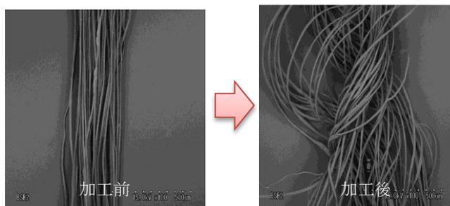
図3 加工糸の顕微鏡写真
