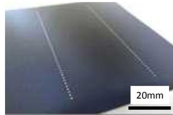
図13 ディスペンサーにより充填された電極
