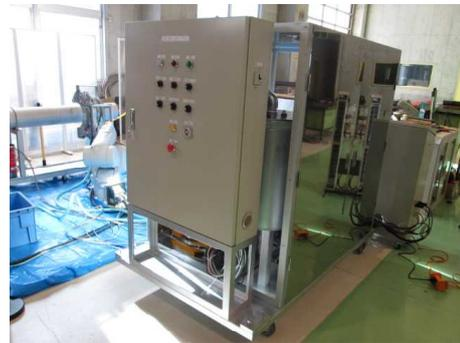
図4 高圧水供給・回収ユニット
