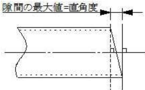
図4 切断面の平面度が小さい場合の直角度
