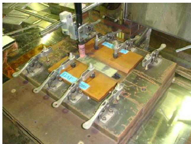
図1 ビードオンプレート溶接実験
