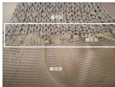
図 4 自動編機による試作品の融合部
