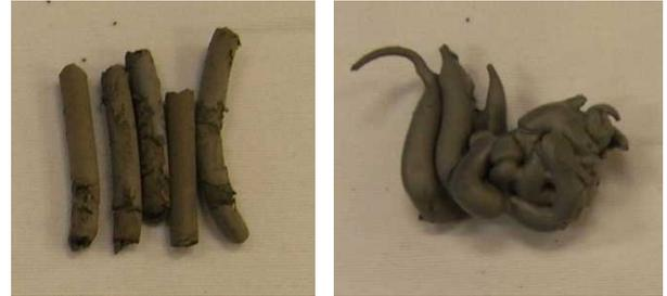
図1 可塑化させたコンパウンドの外観
