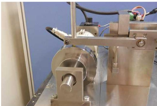
図4 摩擦摩耗試験機
