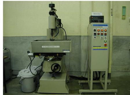
図2 電解砥粒研磨装置
