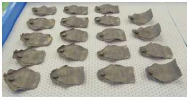
図4 0.2mm厚成型品の脱脂後の外観
