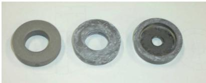
図1 部分据込み試験サンプル
