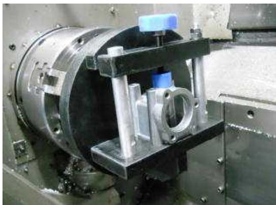
(c) 旋盤に取り付けて被削物を固定したところ
