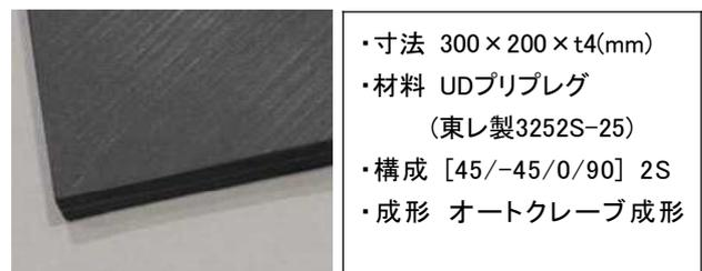
図2 実験で使用したCFRP
