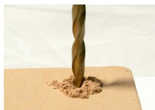
図12 陶板への機械加工
