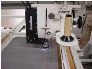
図4 積層材料縫合機
