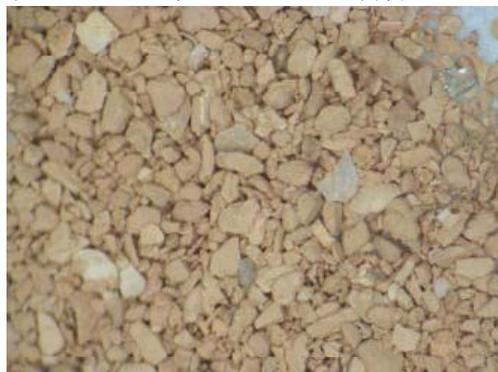
図1 125 μmふるい上残留物
