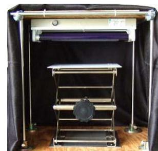
図 3 試作の UV 照射装置
