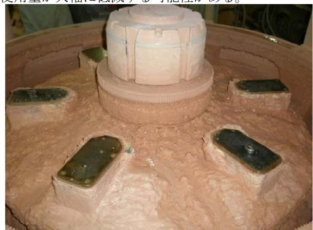
図4 研磨材の堆積した研磨機内部
