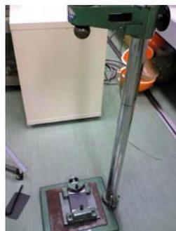
図6 落球衝撃試験
