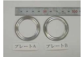
図10 溶接ベローズの部品
