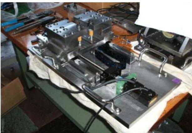
図8 直線周溶接用治具
