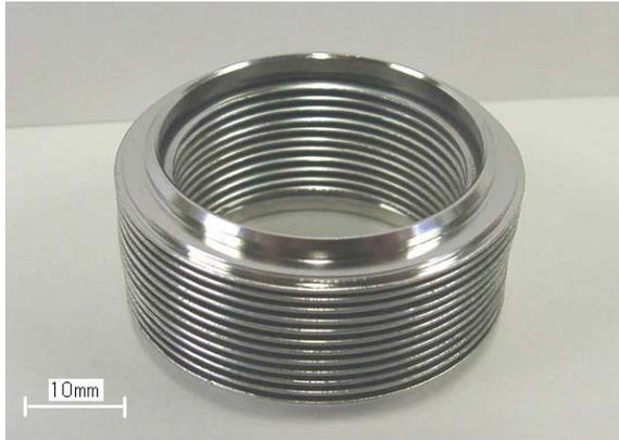
図12 試作した溶接ベローズ
