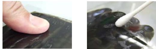
図 2 硬化度評価方法
