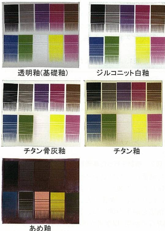
図4 開発した釉薬とテストパターン
