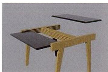
図6. テーブル面抜き差し構造
