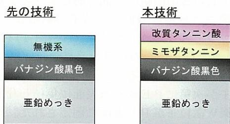
図 8 皮膜断面のモデル図
