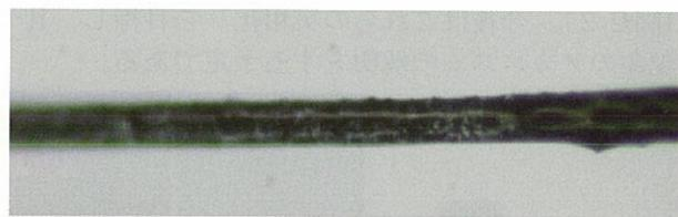
図 10 PE単纖維に固定したW微粒子
