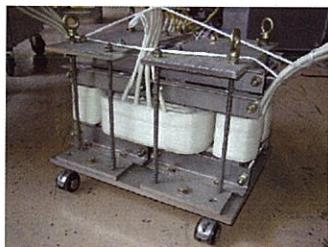
図4 磁束制御型多機能電力調整装置の試作器
