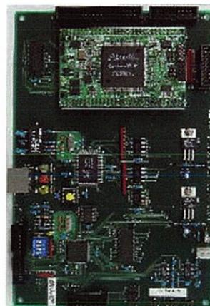
図11 FPGA搭載マイクロコンピュータボード
