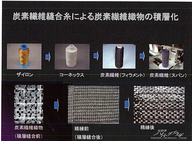
図1 積層材料縫合機縫合糸の推移
