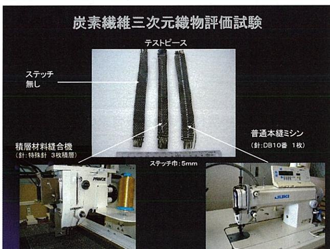
図3 炭素繊維三次元織物の引張強さ試験片
