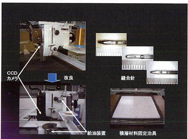
図2 積層材料縫合機の機構
