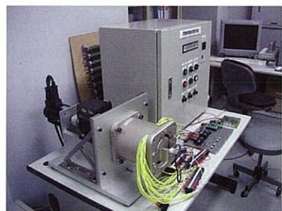
図2 16/12 SR ジェネレータと実験装置
