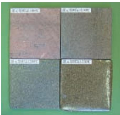
図3 還元雰囲気焼成による江持石の変化
