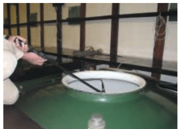
図5 酿造タンク開放面から30cm内部での収音
