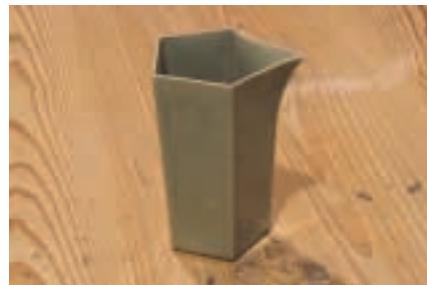
図2 鋳込み成形による試作例(注器)
