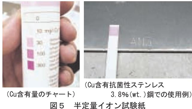
(Cu含有量のチャート) (3.8% (wt. )鋼での使用例)
