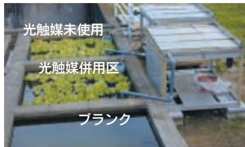
図1 循環式処理用実験装置
