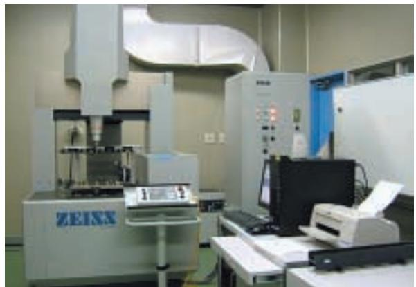
図 3 CNC 三次元座標測定機
