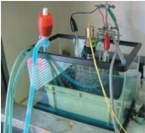
図4 電解処理装置
