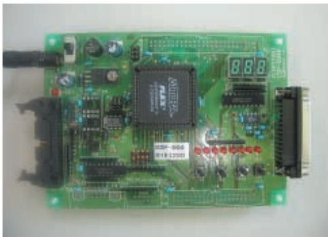
図5 FPGAを使った制御回路
