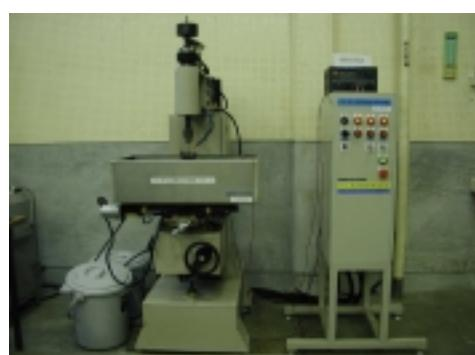
図2 電解砥粒研磨装置
