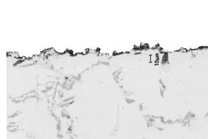
図 6 1.5 A/dm<sup>2</sup> での皮膜断面
