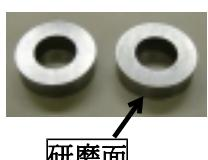
図 10 摩耗試験片
