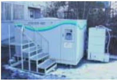
図1 実証試験機外観 左側がコンポスト化醗酵槽、右側のボックスが脱臭槽となっている。また、脱臭槽の略図を図2に示す。
