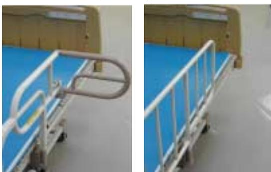
図7 測定に使用した手すり (左:Aタイプ 右:Bタイプ)
