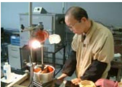
図-1 ミゼットクロメールによる重合漆の精製
