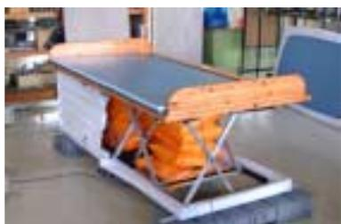
図16 昇降機構部に木部を設置した1次試作
