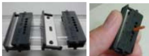
図1 簡易型カッターの構造および切断方法
