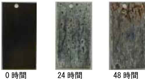
図 3 試料 A の中性塩水噴霧試験の結果
