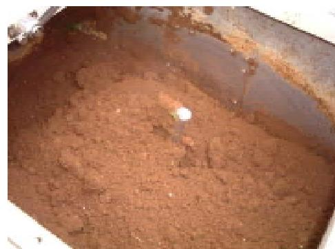
図5 正常時の発酵槽内部の状態
