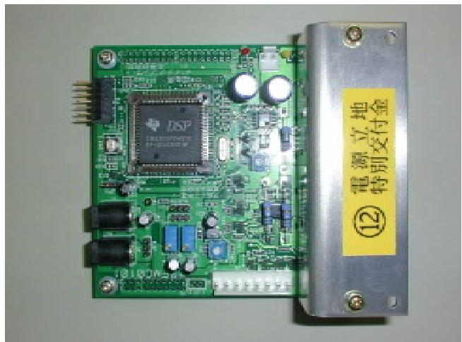
図4 センサレス制御用モータドライブシステムFMC0101
