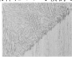
N<sub>2</sub>シートによる溶接金属
