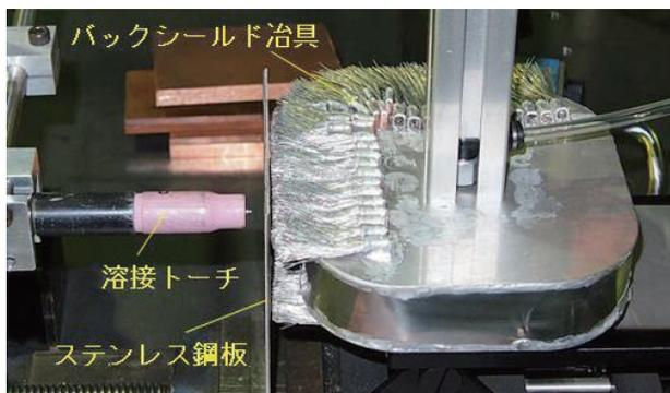
直線部でのスポット溶接実験
