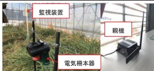
図2 監視装置設置状況
