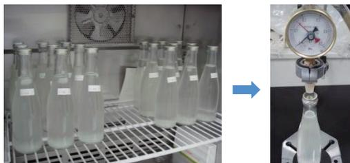
瓶内二次発酵条件検討 → ガス圧安定化
