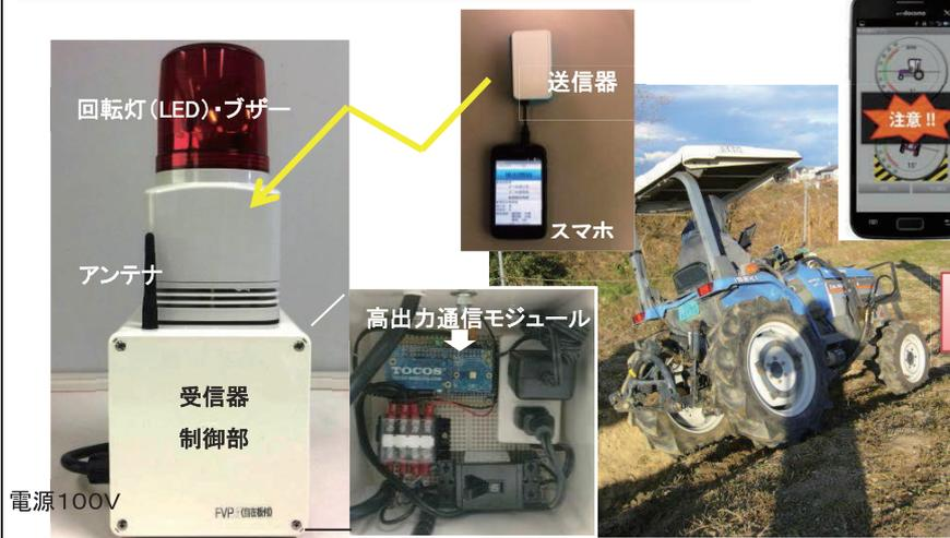
図1 回転灯・警告音緊急事態伝達装置
