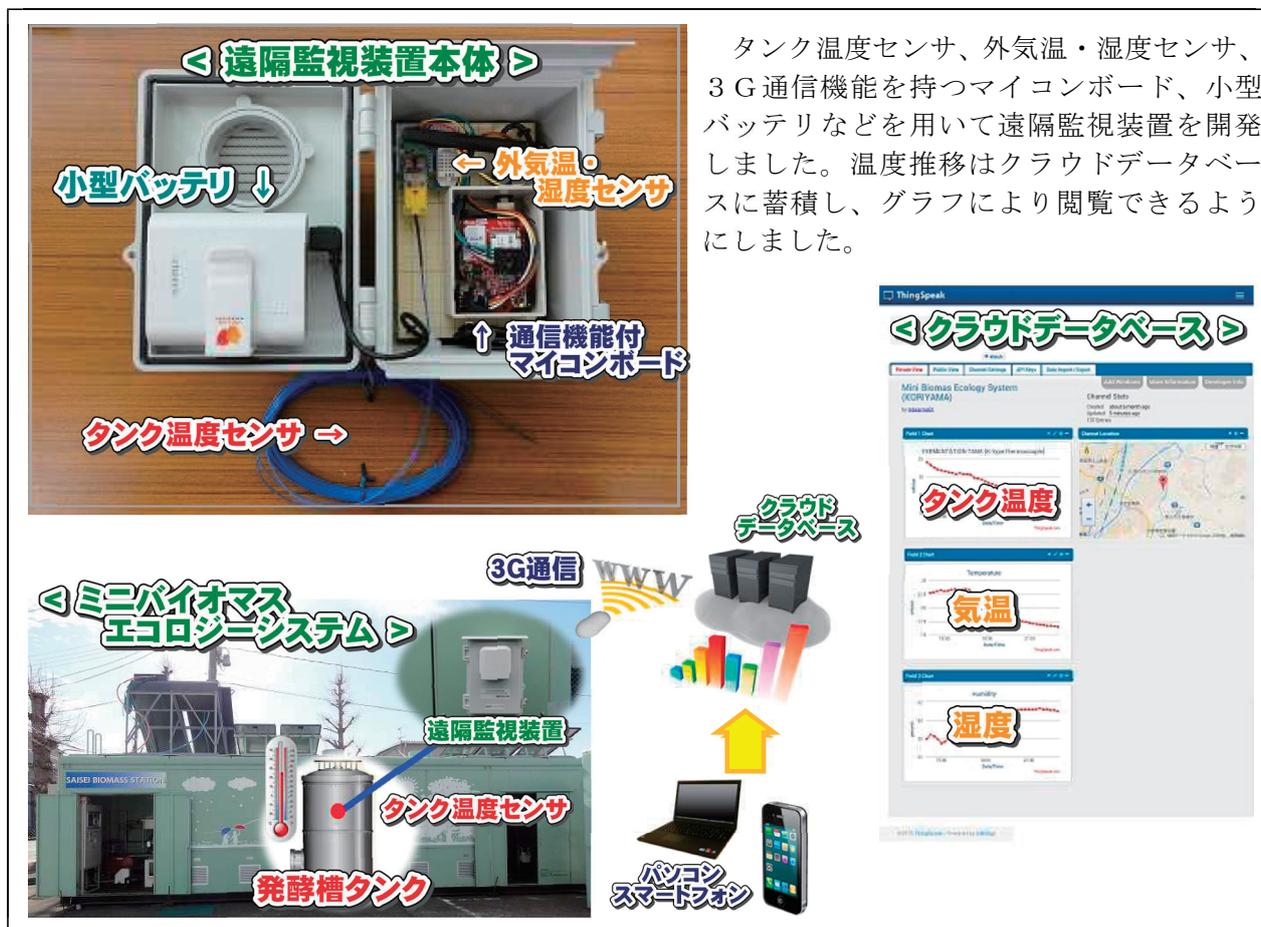
タンク温度センサ、外気温・湿度センサ、3G通信機能を持つマイコンボード、小型バッテリーなどを用いて遠隔監視装置を開発しました。温度推移はクラウドデータベースに蓄積し、グラフにより閲覧できるようにしました。
