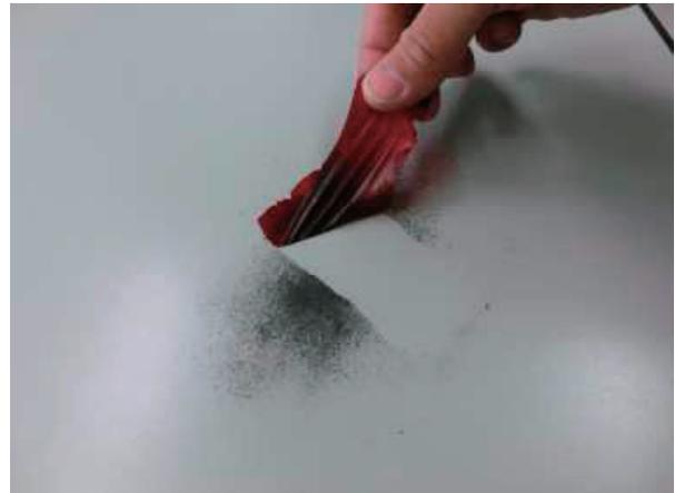
図2 開発した粘着剤による汚染除去実験
