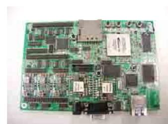
電力変換器制御ボード
