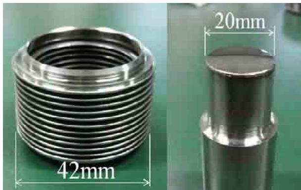
試作品(左:溶接ペローズ、右:圧力センサ用ダイヤフラム)
