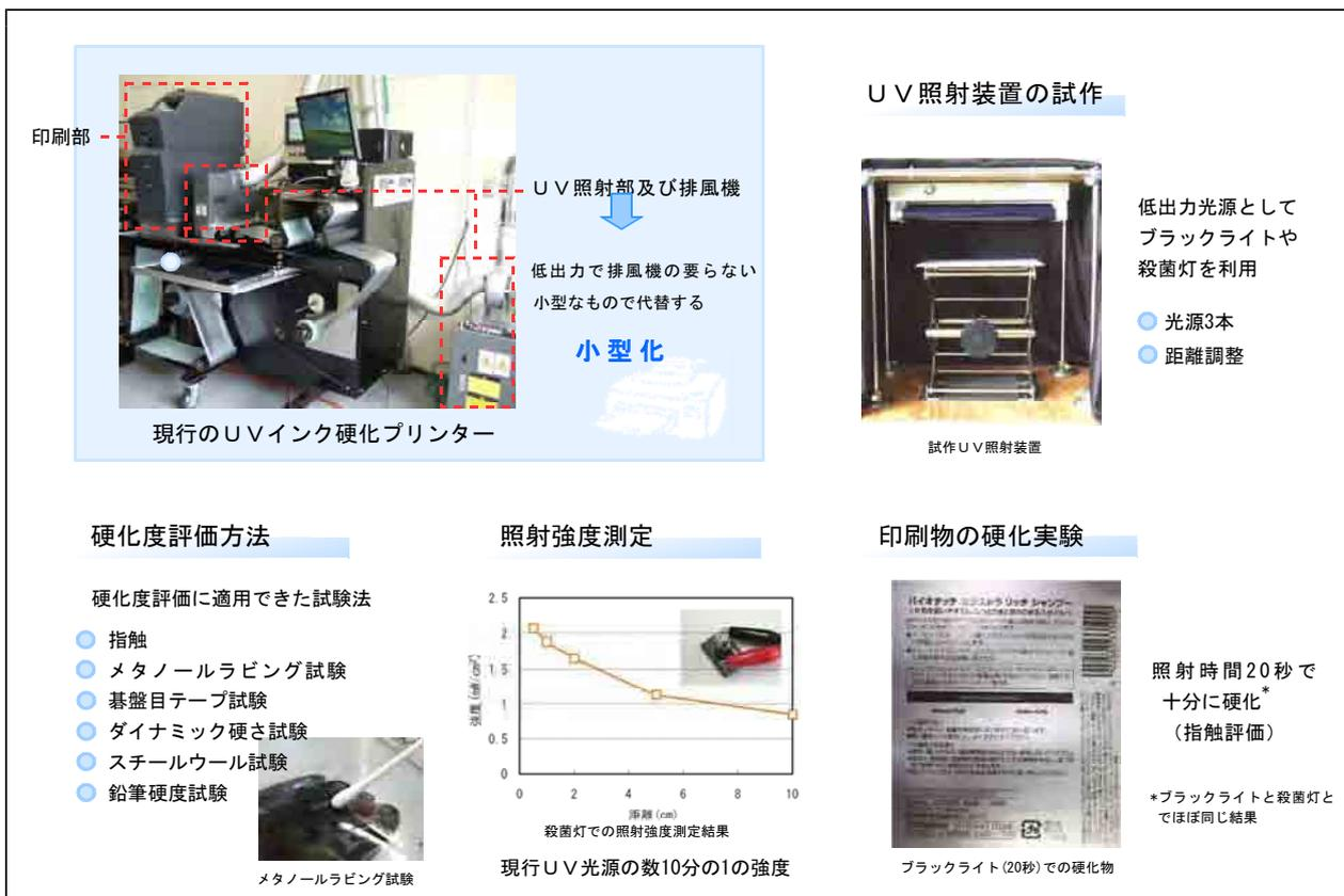
現行の大型UVインク硬化プリンターに用いられているUV照射装置を、排風機などの要らない低出力で小型なものにできないか検討を行いました。UV光源として殺菌灯やブラックライトを用いた装置を試作し実験を行ったところ、照射時間を長くすることで指触では問題ない程度まで印刷物を硬化することができました。
