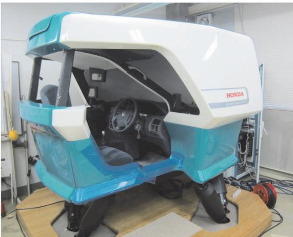
図 2.2.1. ドライビング・シミュレータ
