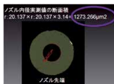
図 3 6 ノズル先端計測結果
