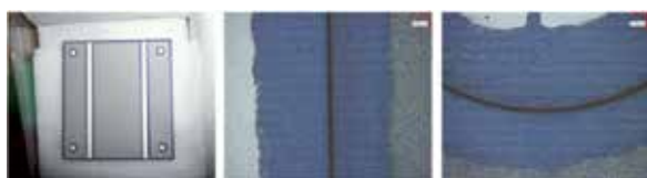
図 17 エッジアイソレーション加工サンプル
