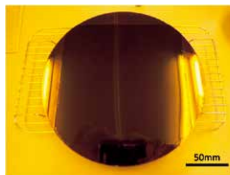
図 4 両面接着シート張り合わせウェハ
