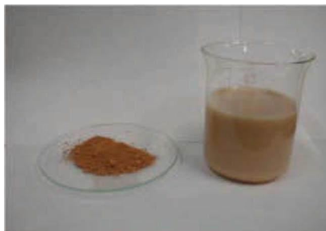
図1 研磨材(左)と廃研磨材(右)
