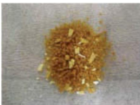
図 5 研磨材  $H_2SO_4$  溶解による希土類水酸化物写真
