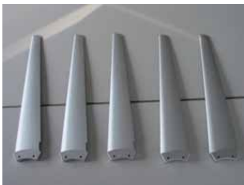
図6 ブレード Ver.2 試作品（片側切り込み）
