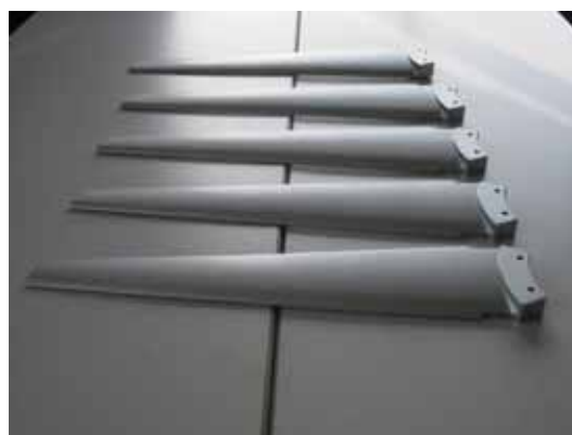
図4 ブレード Ver. 1 試作品（両側切り込み）
