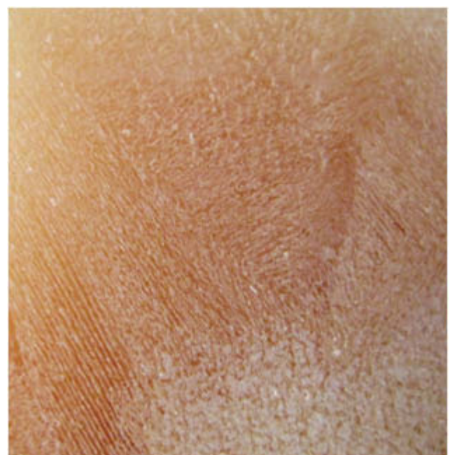
図13 凍結させたスラリーの断面
