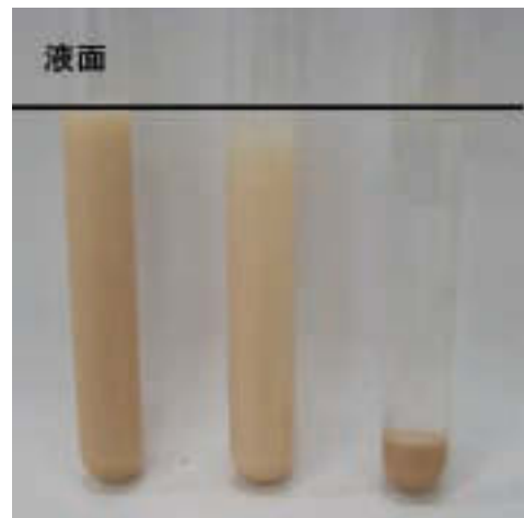
図12 自然沈降と凍結解凍分離の比較
