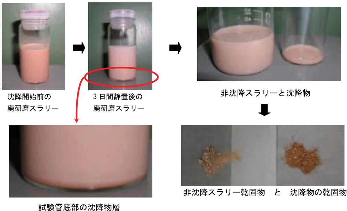
図1 廃研磨スラリーからの沈降試験
