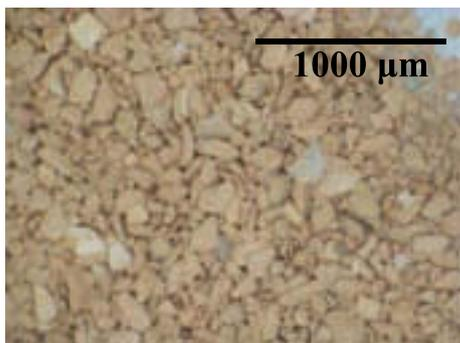
図4 ふるい（目開き 125  $\mu\text{m}$ ）上残留物
