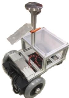
図11 自律走行評価用ロボットの外観
