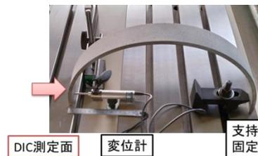
図8 DIC測定精度試験状況
