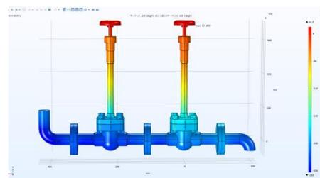
図18 温度分布（液体水素冷却の場合）
