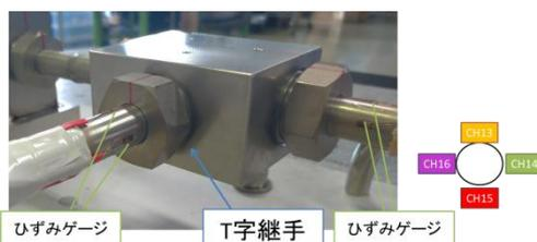
図12 荷重試験時のひずみ測定状況
