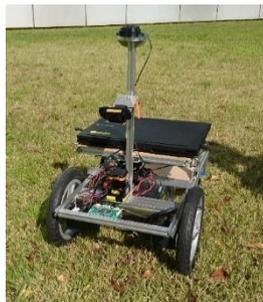
図3 センサ評価ロボットの外観
