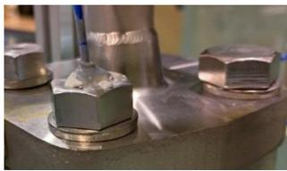
図3 ボルトへの熱電対の取付状況
