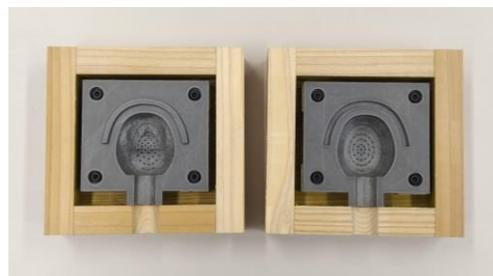
図6 改良した量産用型と木製外枠
