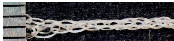
図10 緯糸用リリヤーン糸(加工後織度:560[D])
