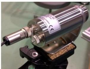
図4 組込み用途向け小型サーモカメラ
