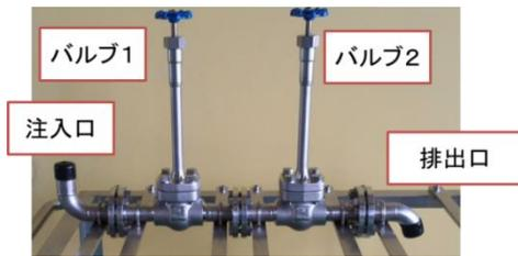
図2 バルブ実験モデル
