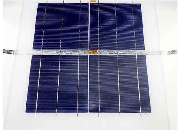
図15 温度測定用のミニモジュール
