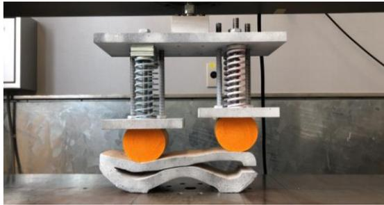
図5 圧縮試験の様子
