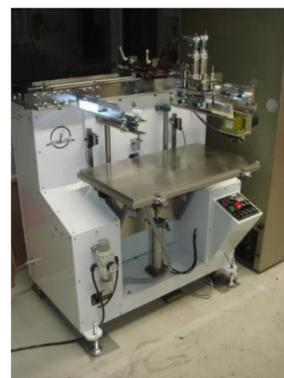
孔版式平面・曲面印刷機
