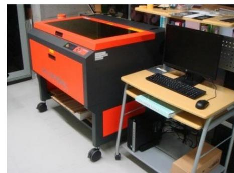
レーザー式精密加工機
