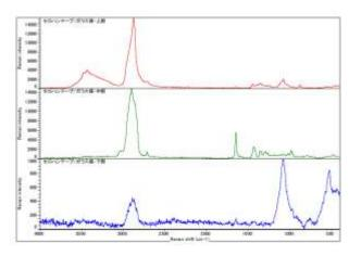
上部、中部、下部でデータが異なることが分かる。 それぞれのデータをライブラリと照合すると、セロファン(レーヨン)、イソプレンゴム、ガラスであることが分かる。このように、非破壊で表面から材料の特定ができる。
