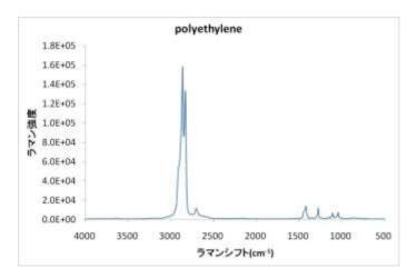
ラマン分光分析の測定データは、縦軸がラマン強度、 横軸がラマンシフトで表わされる。ラマンシフトとは、 レーザー光に対してどれだけ波長がずれているかを 示す値であり、単位は FT-IR と同様に cm<sup>-1</sup>(カイザー) で示される。ラマン強度は散乱光の検出量である。
