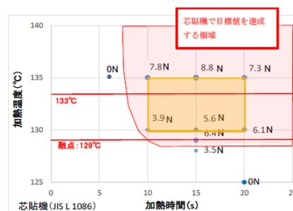
図4 加熱温度と加熱時間による剥離強度の変化
