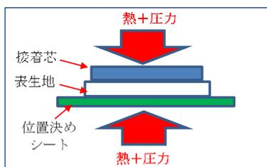
図2 接着工程の概略図
