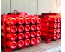
水素カードル
