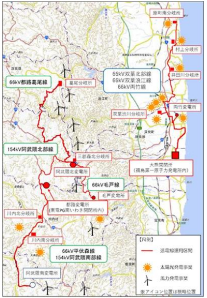
共用送電線の整備
