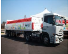
水素トレーラー
