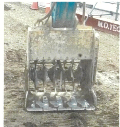
深耕・耕耘が同時にできる ミキシングバケット
