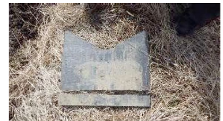
排水調整板 (全景)
