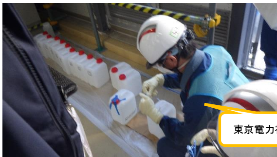
(写真 2) 東京電力社員による採取済のポリ瓶 へのシーリング実施状況
