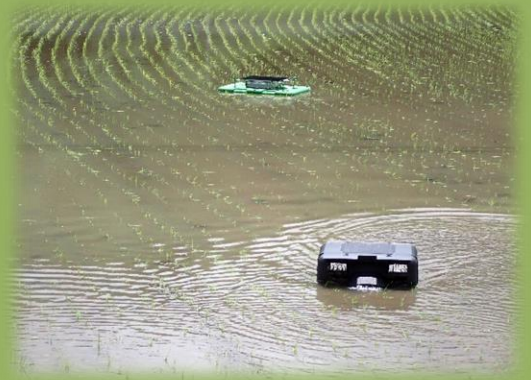
水田内を自動航行するアイガモロボ (郡山市)
