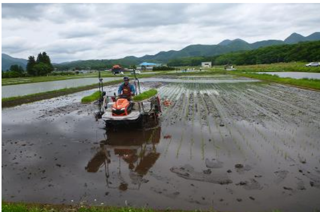
自動操舵田植機による田植え作業
