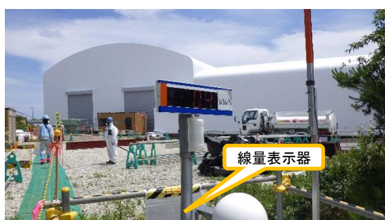
(写真 3) 線量表示器の設置状況 (当日の計測値 : 0.4 \mu Sv/h)
