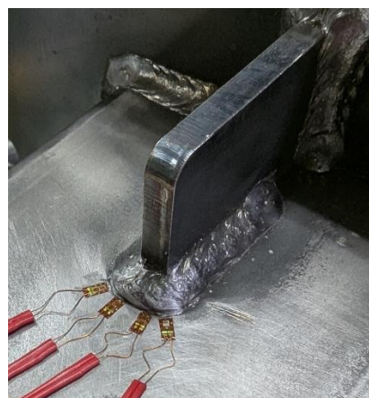
図5 ひずみゲージ貼付状況
