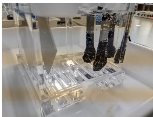
図3 陰極水素チャージ試験の試験片浸漬状態
