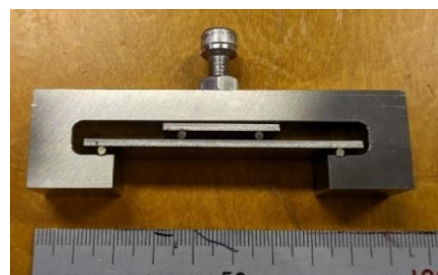
図8 応力腐食曲げ試験片と曲げ治具
