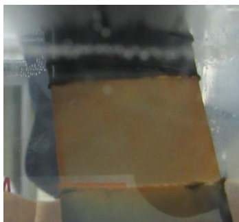
図 1 5 茶褐色の腐食生成物が生じた状況 (強度 440MPa 炭素鋼の場合)
