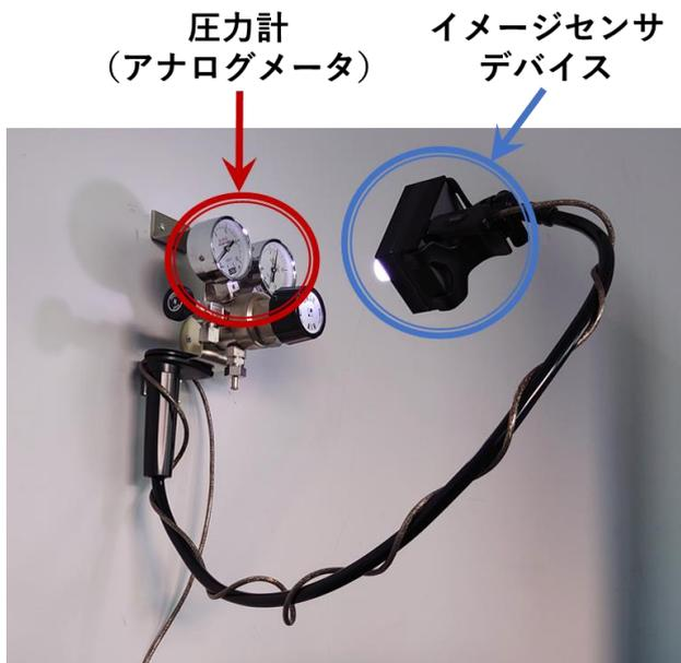
図5 圧力計へのイメージセンサデバイス設置
