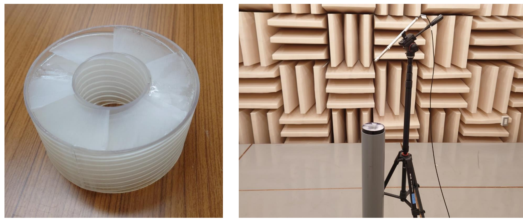
図2 作成した音響メタマテリアルと実験の様子
