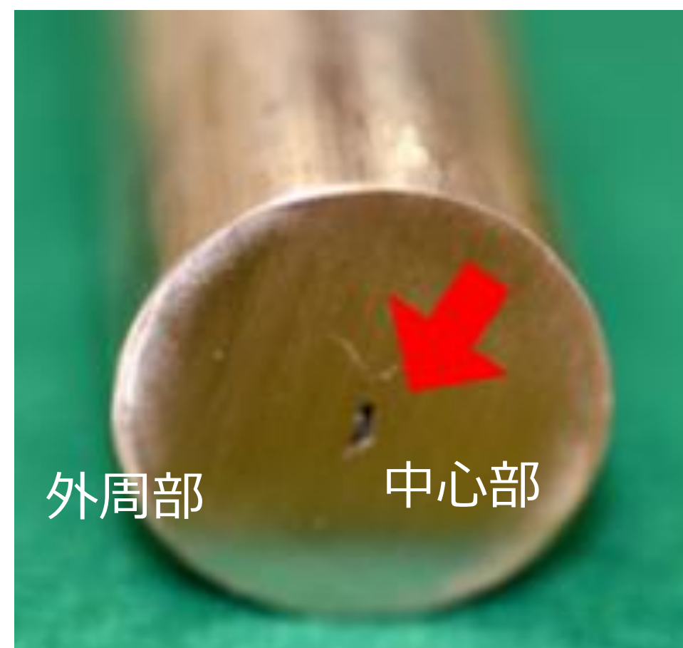
図1 中心部に発生する割れ
