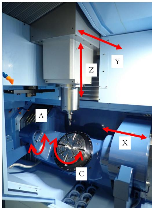
図1 5軸MCの軸構成
