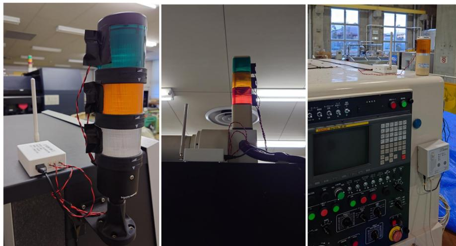
図1 加工機へのIoTデバイス取付け
