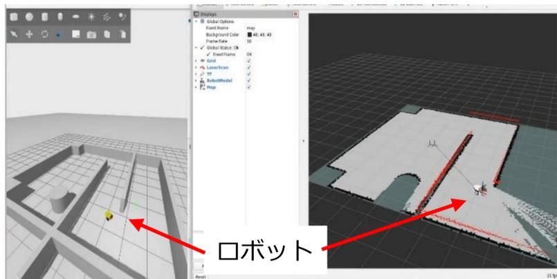
図1 シミュレーション上での地図作成の様子
