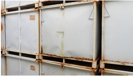
(写真3②) コンテナの腐食状況
