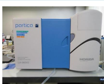
レーザー回折散乱式粒度分布測定装置
