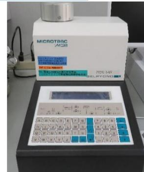
ガス置換型粉体密度測定装置
