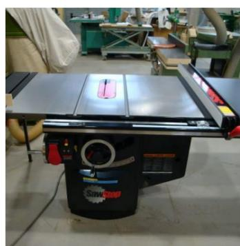
鋸軸傾斜丸鋸盤
