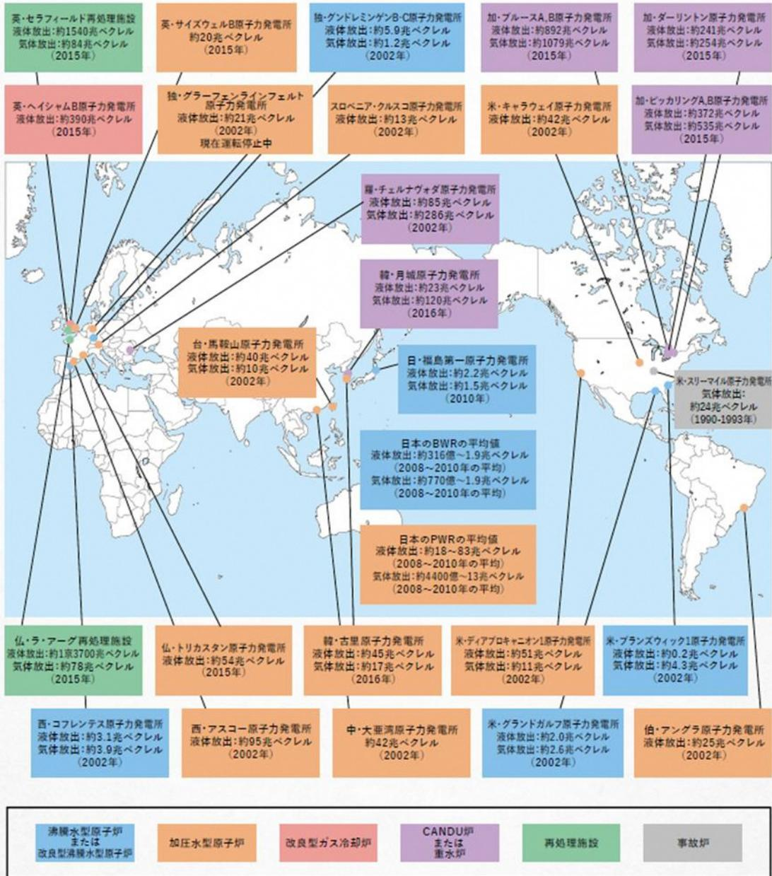
※枠内の数値はトリチウム排出量を示す。(参考)トリチウム1兆ベクレルを、トリチウムを含む水に換算すると約0.019グラムに相当。
