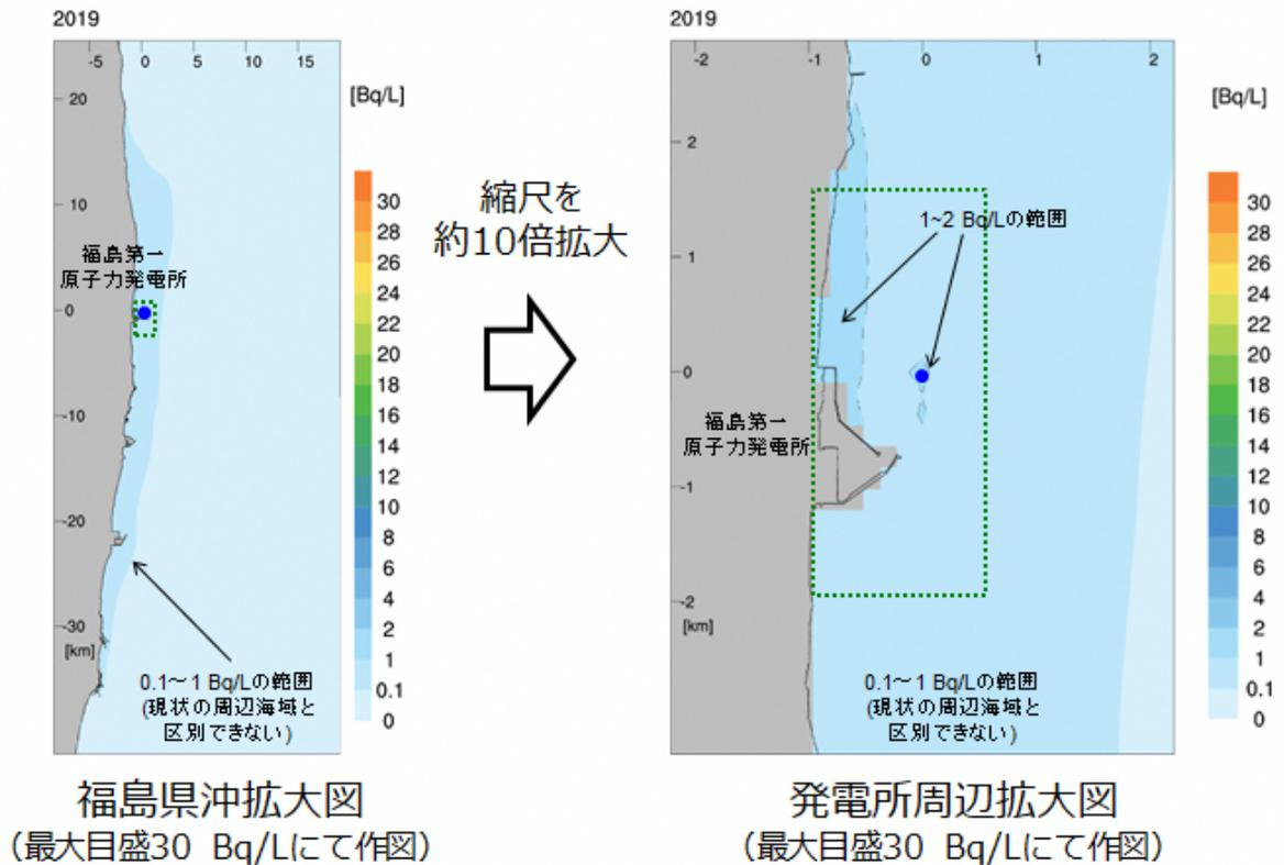
※：シミュレーションは、米国の大学で開発、公開され各国の大学・研究機関で使用されている海洋拡散モデル (ROMS) に電力中央研究所が改良を加えたプログラムを用いて実施
