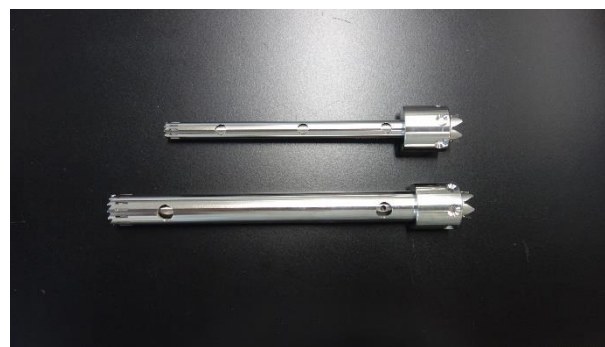
ジェネレーターシャフト 上：Φ12mm、下：Φ20mm
