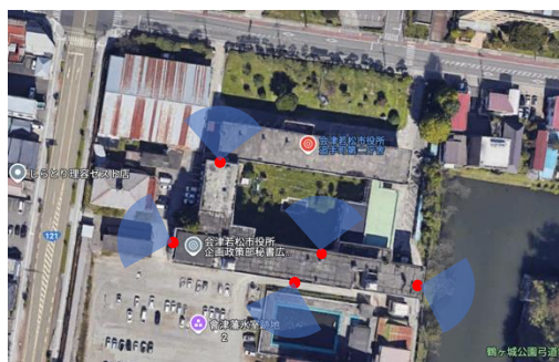
図4. 会津若松市役所追出町第二庁舎屋上におけるカメラ設置位置と画角
