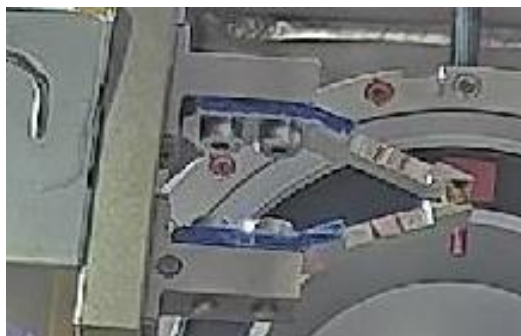
先端治具が燃料デブリを把持している状況 （4月22日エンクロージャ上部から撮影）
