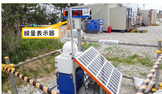
(写真 3) 線量表示器の設置状況 (当日の計測値：0.4 \mu\text{Sv/h} ) (南東側から撮影)
