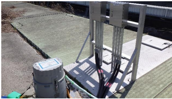
(写真 4－1) 新設されたP S Fモニタの状況① （B C排水路の本流に直付け）
