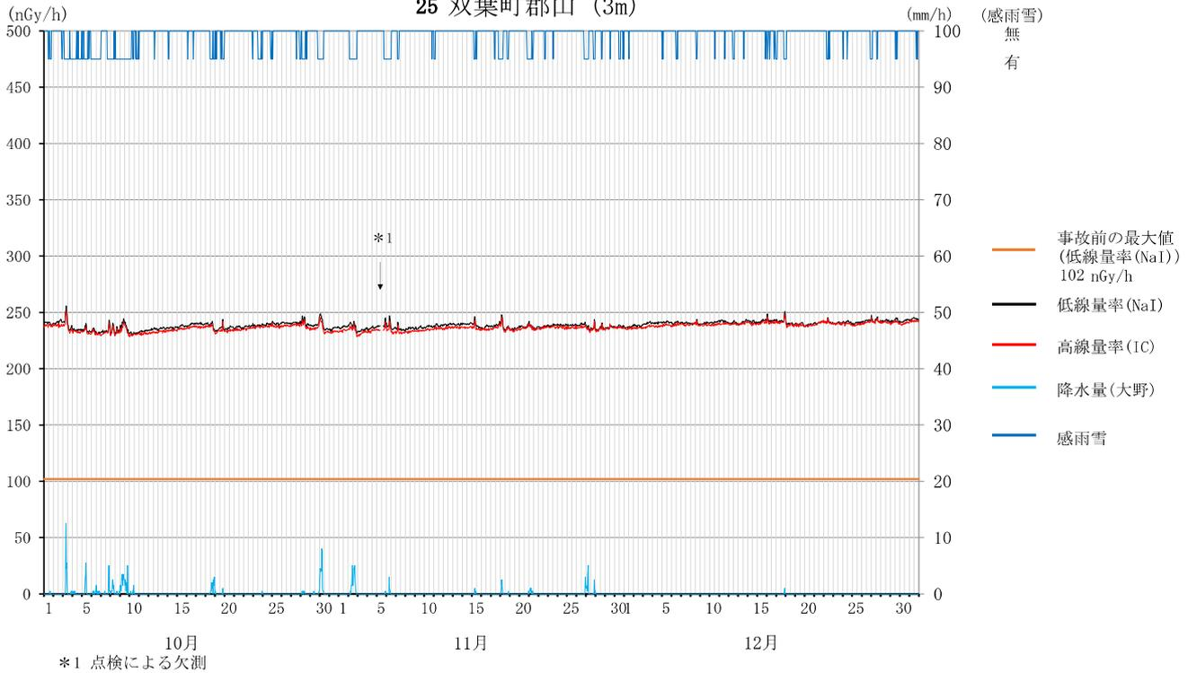
電離箱式検出器 (IC) は高エネルギーの宇宙線についても測定できることから、線量率が低レベルのときの測定値はNaI (TI) シンチレーション式検出器より30nGy/h程度高くなる。また電離箱式検出器は、検出器の形状が球形であり方向特性が良好である一方、NaI (TI) シンチレーション式検出器の形状は2inφ×2inの円柱状であるため、鉛直方向の方向特性を1とした場合、90度方向では1.1程度となる。線量率が数百nGy/h以上の地点では、福島第一原子力発電所の事故により沈着したCs-134及びCs-137による地表面方向 (90度から180度) からの放射線が大部分を占めるため、検出器の方向特性の違いによる影響がより顕著に現れ、電離箱式検出器と比較してNaI (TI) シンチレーション式検出器の測定値が高い傾向となる。
