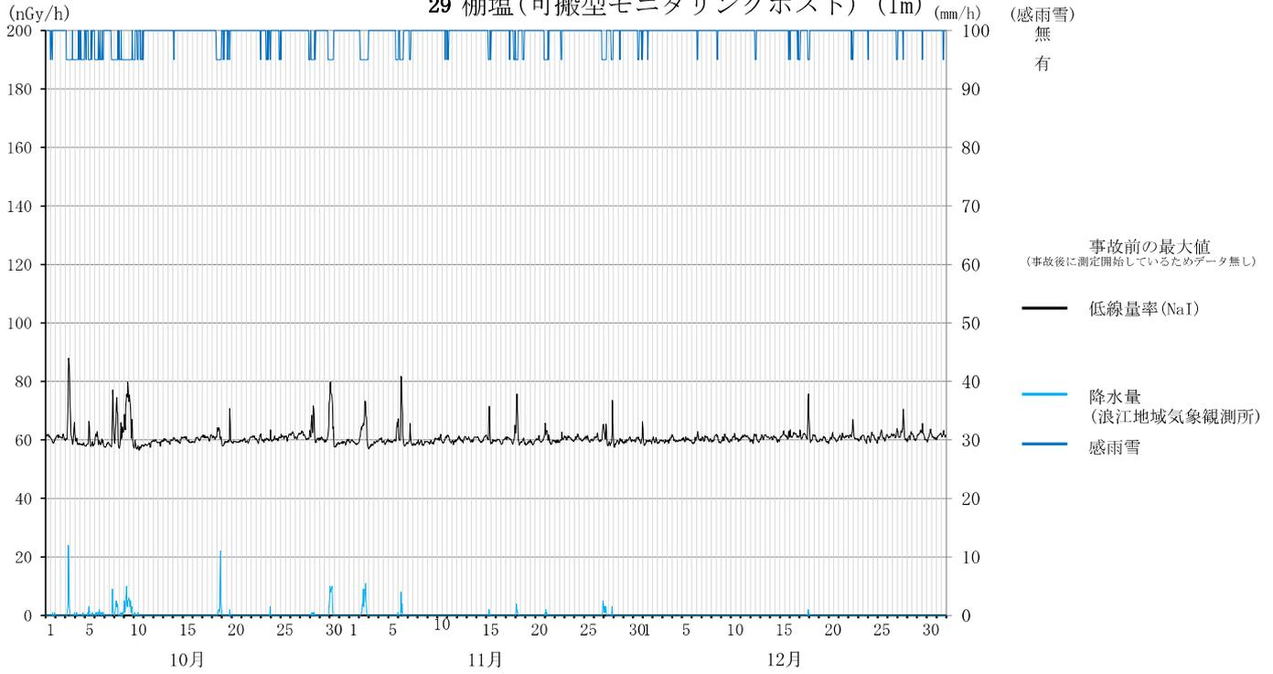
可搬型モニタリングポストには温度制御装置が装備されていないため線量率が気温の変動による影響を受けて日周期で変動する。
